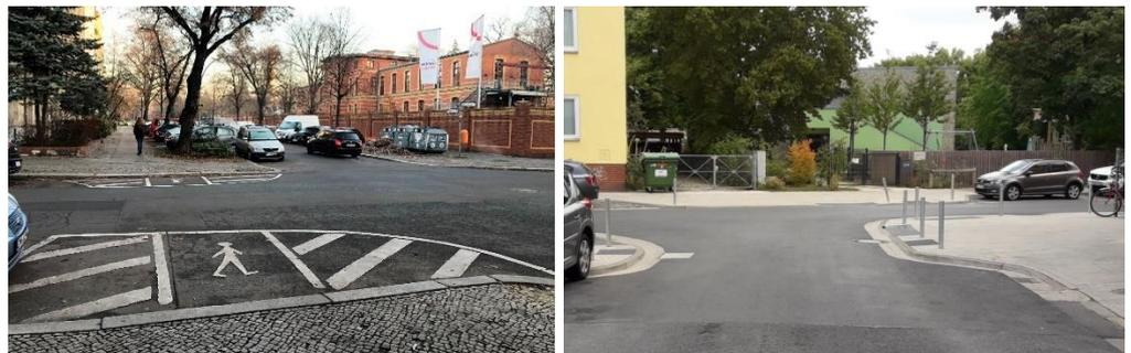
Abb. 35 Vorgezogener Seitenraum (links Markierung, rechts baulich)
