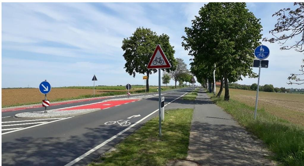
Abb. 54 Markierung von Fahrradpiktogrammen auf der Fahrbahn Übergang Fahrbahnführung innerorts und außerorts ben. RVA (Seelze)
