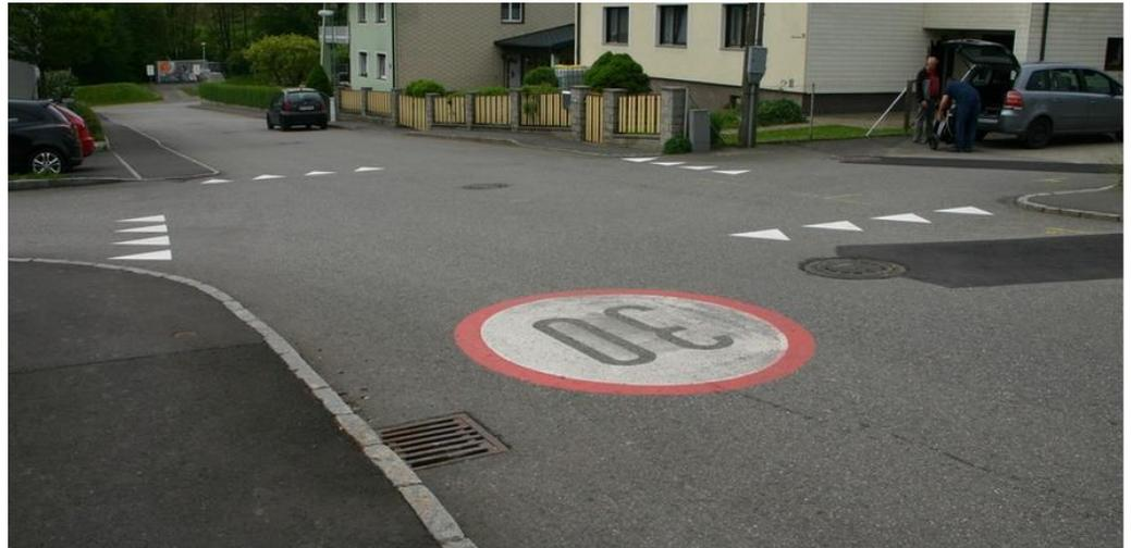
Abb. 26 Haifischzähne zur Verdeutlichung der Rechts-Vor-Links Regelung in Tempo-30-Zonen (Quelle: Leitner)
