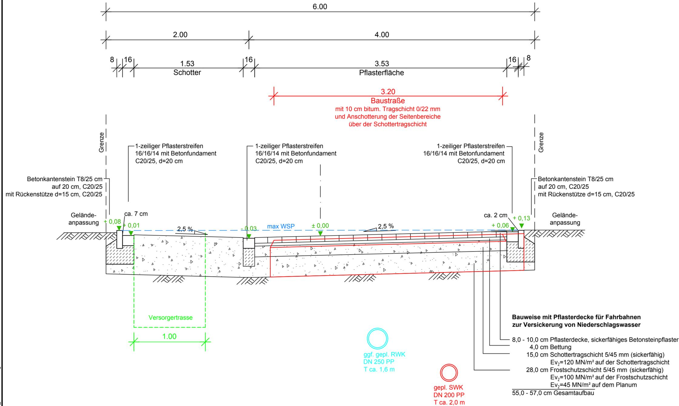
Der Unterbau für das Sickerpflaster
